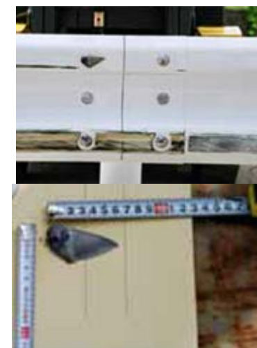
■実車実験により付着した金属片(ボルト部)
