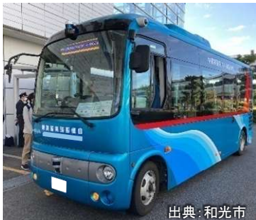
先進モビリティ：埼玉県和光市 (車載センサによる自車位置特定)
