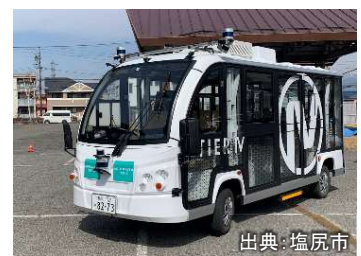
ティアフォー：長野県塩尻市 (車載センサによる自車位置特定)
