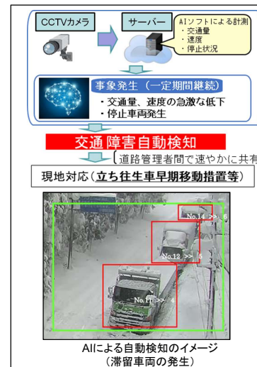
交通障害自動検知システム
