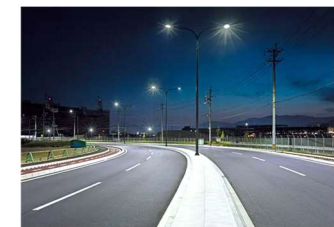
LED照明による省エネ効果 消費電力約6割削減 (高圧ナトリウム灯比)
