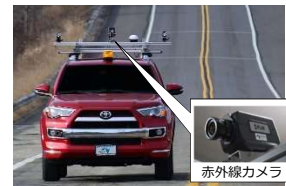
赤外線カメラによる コンクリート床版の点検
