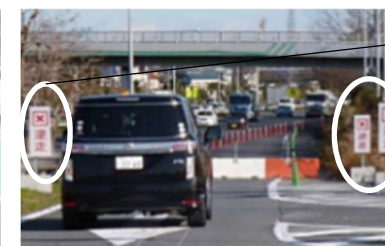
逆走警告用看板を車載カメラが読み取り、 ドライバーに警告を発出
