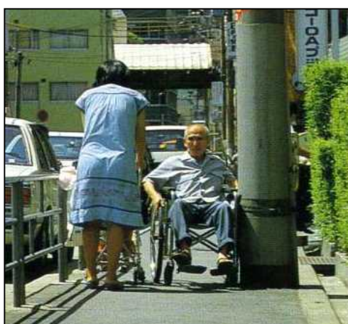
<歩行の支障となる電柱>
