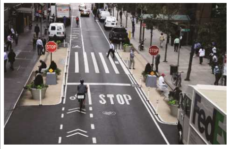
横断歩道部を張り出して、横断距離を短くする 出典: NACTO ホームページより
