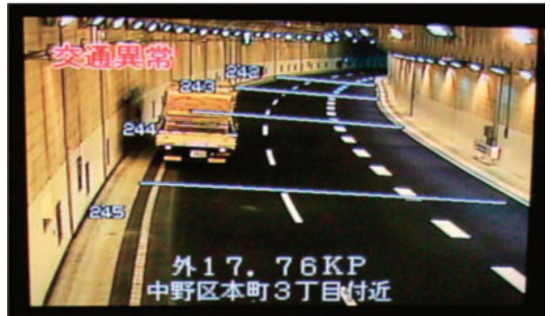
交通異常事象検出システムの検出画面
