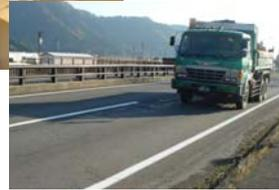
荷重車走行時の部材各部のひずみを計測
