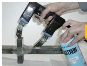
磁化および磁粉検査液の散布
