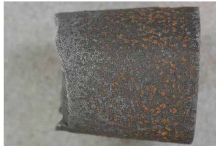
(e) 破断部側面(錆除去後) (主に錆が残っている部分が孔食)
