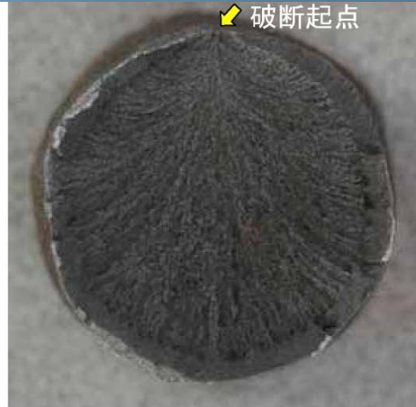
(b) 破面写真(錆除去後)
